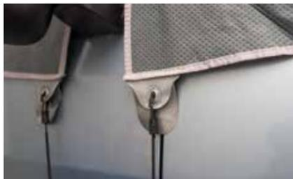
← Entlang der Unterkante befinden sich Abspannlaschen mit verstärkten Kunststoffösen. Zum Schutz vor Reibung auf der Lackierung sind Schutzlaschen verarbeitet.
